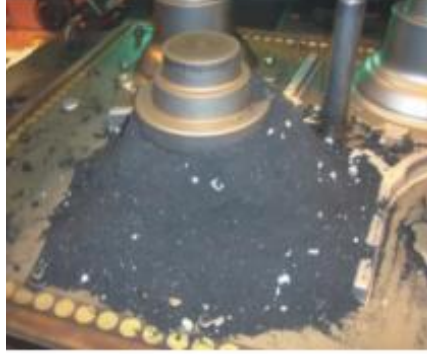
Şekil 1.3. Kalıp kumu ile yanmamış besleyici gömlek kırıntılarının karışımı [7].
